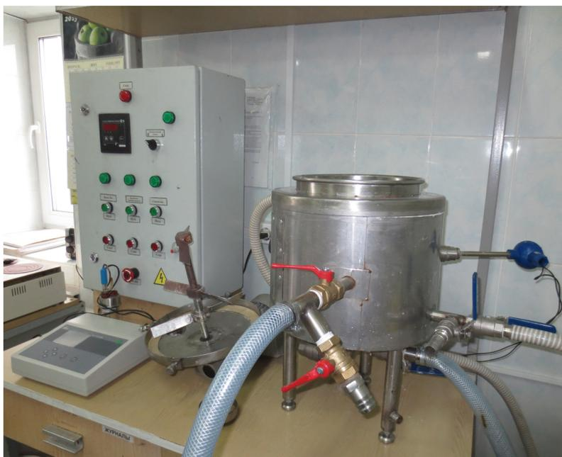
Рис. 5. Установка гидролиза крахмала Ш12-УГК
