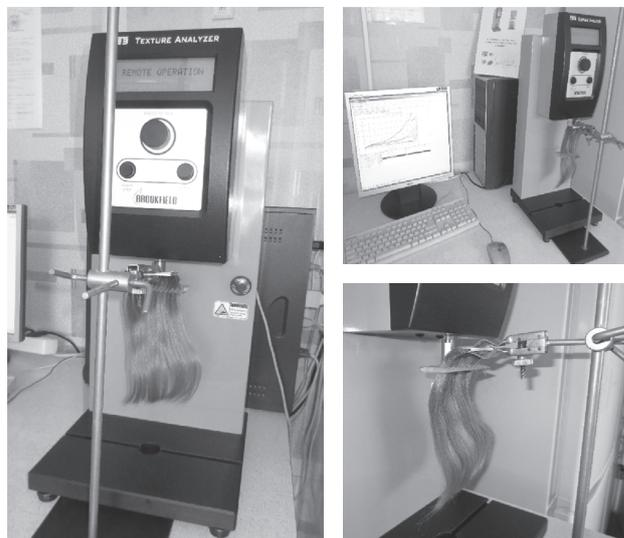
Рис. 5. Измерение расчесываемости прядей волос на текстурометре Brookfield
