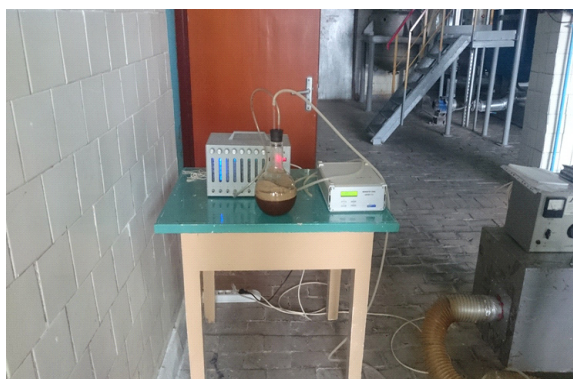
Рис. 1. Схема установки для обработки суспензии продуцента лимонной кислоты: 1 — озонатор модели ЭРГО-М; 2 — суспензия препарата конидий продуцента лимонной кислоты; 3 — аспиратор (модель ОП-824ТЦ); 4 — газоанализатор «ЦИКЛОН-5.51»; 5 — системы трубок
