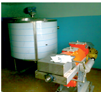
Емкость для дробины Ш12-ЕНД и сепаратор для обезвоживания пивной дробины
