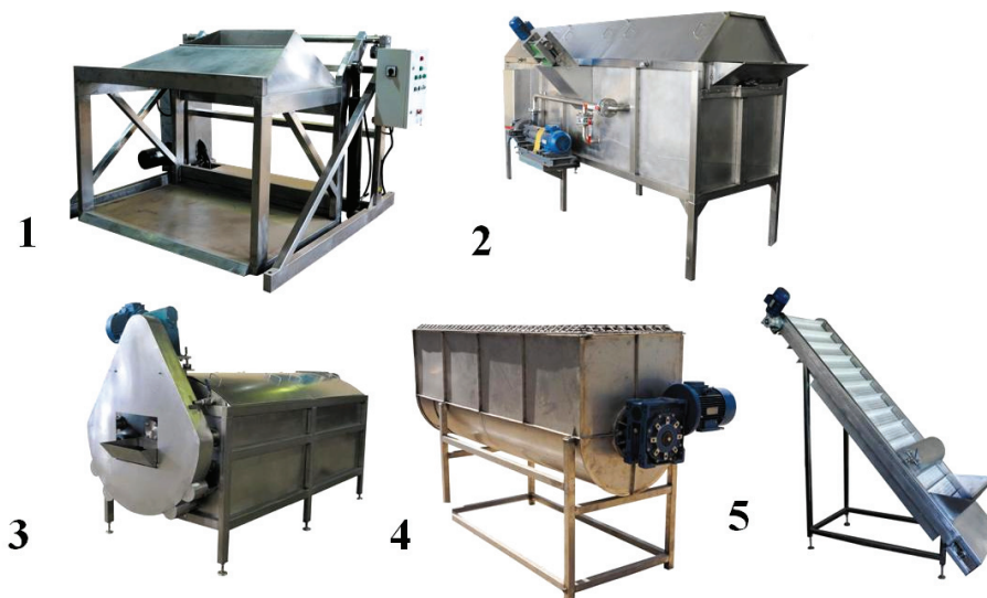
Рис. 2. Отдельные единицы оборудования многофункциональной линии по вакуумированию картофеля и топинамбура: 1 — контейнероопрокидыватель Ш12-ККТ, 2 — машина моечная барабанная Ш12-ММТ, 3 — машина моечная щеточного типа Ш12-МШТ, 4 — ванна обработки растворами пищевых добавок Ш12-ВОД, 5 — конвейер передающий Ш12 — КПД
