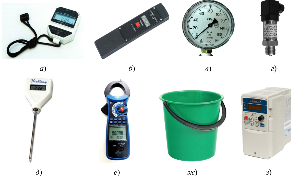
а – секундомер электронный «Интеграл С-01»; б – тахометр оптический бесконтактный ДО-01Р; в – манометр МП-100; г – датчик давления микропроцессорный СЕНСОР-М-125-Н-t2-0,25; д – термометр СНЕКТЕМР; е – токоизмерительные клещи-ваттметр-мультиметр АСМ-2352; ж – мерная емкость 10 л; з – векторный преобразователь частоты ВЕСПЕР Е2-8300
