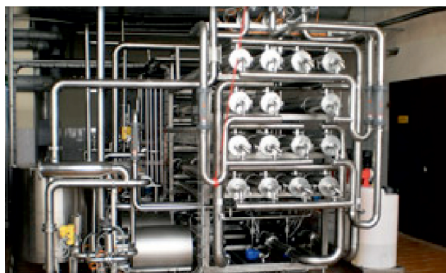
Рис. 2. Фотография УФ установки для получения концентрата желатина ( http://gelatin.by/pictures/production-gelatin-3.jpg , дата доступа 11.06.2019 г.) [3] Fig. 2. Photograph of the UF apparatus for gelatin concentrate obtaining. ( http://gelatin.by/pictures/production-gelatin-3.jpg , access data 11.06.2019) [3]
