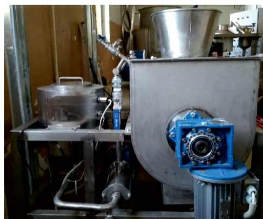
Рис. 2. Смеситель Ш12-РСК: 1,2 — корпус; 3 — вал с ленточной мешалкой; 4 — мотор-редуктор; 5 — рама; 6 — система ввода жидких компонентов; 7 — магнитная ловушка
