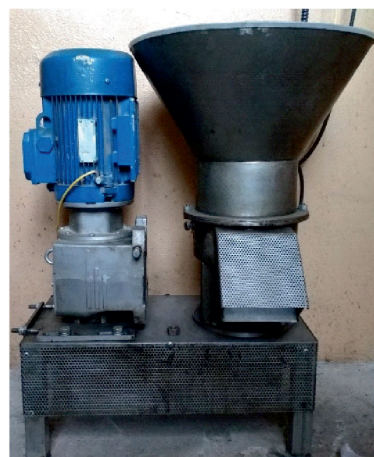
Рис. 5. Пресс-гранулятор Ш12-РПГ: 1 — загрузочный бункер, 2 — корпус, 3 — датчик температуры, 4 — ролики, 5 — вал, 6 — матрица, 7 — нож, 8 — крыльчатка, 9 — ременная передача, 10 — рама, 11 — лоток для выгрузки, 12 — мотор-редуктор
