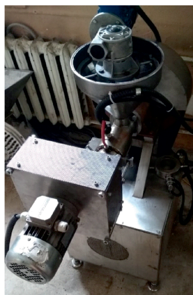
Рис. 4. Экструдер Ш12-РЭК: 1 — корпус; 2 — шнек; 3 — фильера; 4 — шнековый питатель; 5 — привод шнека; 6 — нож с приводом для обрезки гранул; 7 — рама Fig. 4. Extruder SH12-REK: 1 — housing; 2 — auger; 3 — die; 4 — screw feeder; 5 — auger drive; 6 — a knife with a drive for cutting granules; 7 — frame
