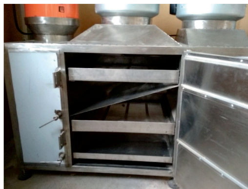
Рис. 6. Охладитель гранул Ш12-РОГ: 1— опоры; 2 — корпус, 3 — заслонки, 4 — изоляция, 5 — электронагреватель; 6 — вентиляторы канальные; 7 — лотки с сетчатым дном для гранул, 8 — лоток для сбора масла, 9 — дверь
