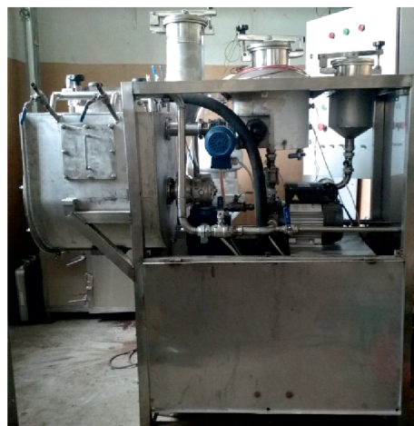
Рис. 7. Обмасливател Ш12-РНВ: 1 — рама, 2 — корпус с вакуумной камерой и валом с лопатками, 3 — привод вала, 4 — система вакуумирования, 5 — система подогрева и распыла масла, 6 — система подачи порошкообразных компонентов, 7 — система подачи жидких компонентов, 8 — насосы для подачи жидкостей, 9 — контрольно-измерительные приборы, 10 — пульт управления
