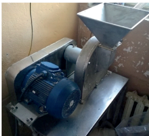
Рис. 1. Дробилка Ш12-ДСК: 1 — загрузочный бункер; 2 — корпус; 3 — опора; 4 — измельчающий механизм; 5 — электропривод; 6 — сито
