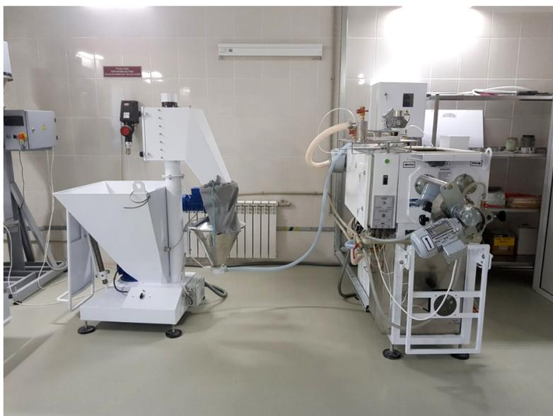
Рис. 1. Оборудование для производства короткорезанных макаронных изделий
