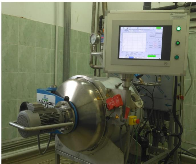
Рис.3. Лабораторный автоклав Lagarde Франция с системой сбора и регистрации температур Samanta
