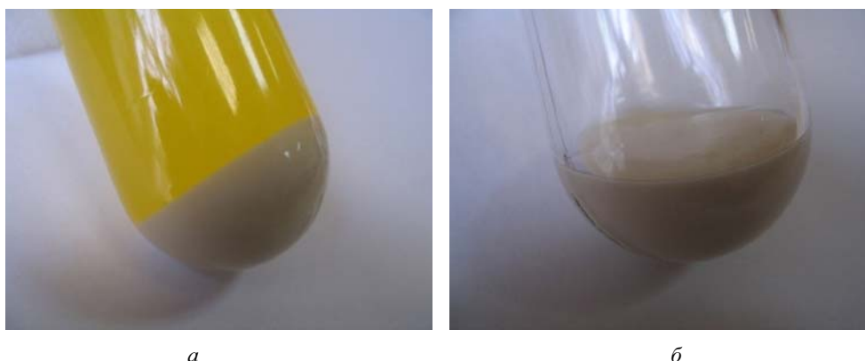
Рис. 7. Наноструктурированное ультразвуком в присутствии воды подсолнечное масло после центрифугирования (а), фосфолипидная эмульсия после слива супернатанта (б)
