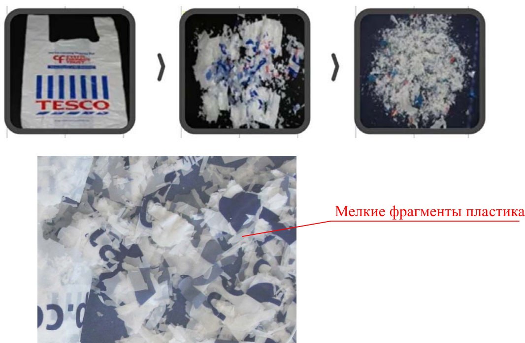
Рис. 2. Пример фоторазложения оксоразлагаемого пакета типа «майка» при попадании прямых солнечных лучей Fig.2. An example of photodegradation of an oxo-decomposable «T-shirt» -type bag in direct sunlight
