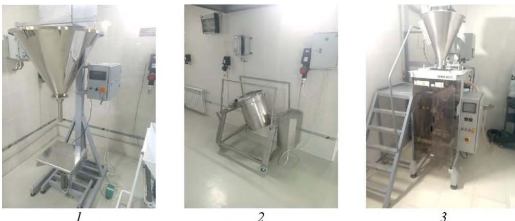
Рис. 4. Линия по производству сухих смесей:
