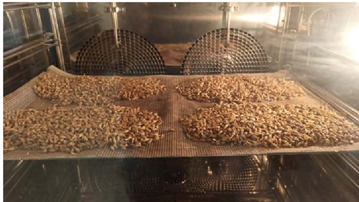
Рис. 3. Контрольная сушка обработанных образцов Fig. 3. Control drying of treated samples
