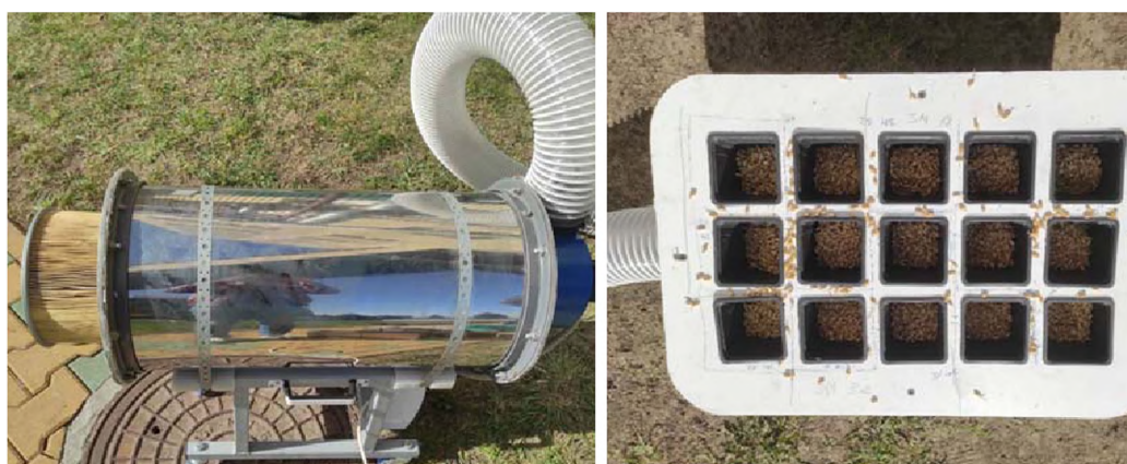
Рис. 2. Обработка свежепорощенного солода электроактивированным воздухом Fig. 2. Processing of freshly brewed malt with electroactivated air
