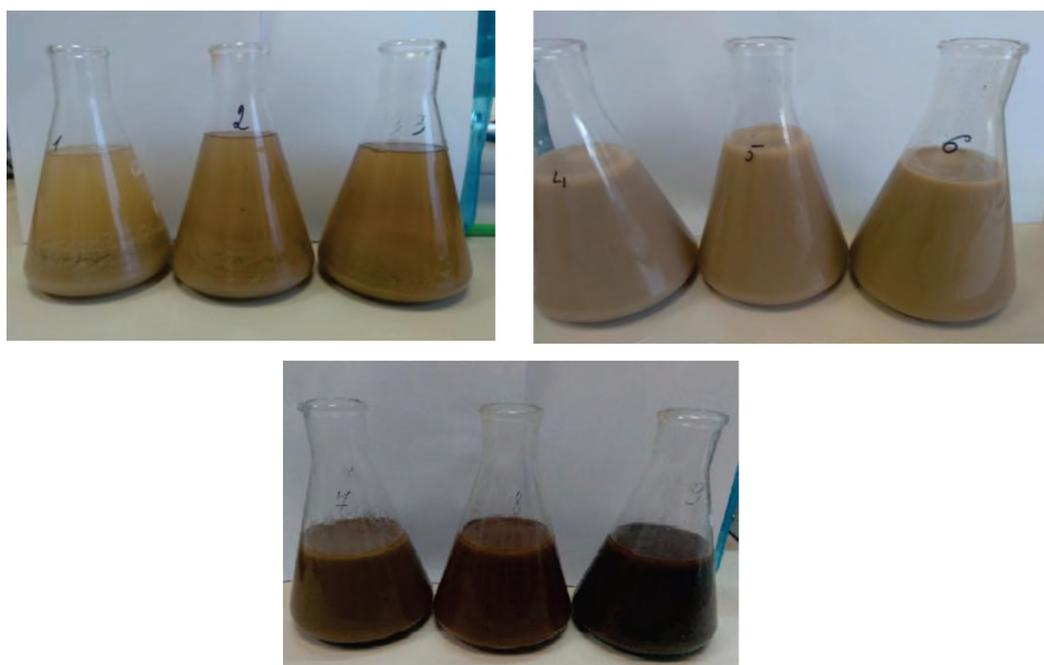
Рис. 1. Образцы белково-хмелевого отстоя после процесса кислотного гидролиза
