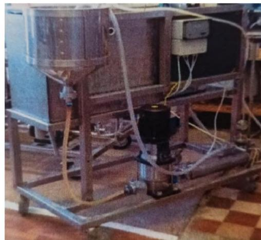
Рис. 2. Лабораторная ультрафильтрационная установка Я23-ОУФ
