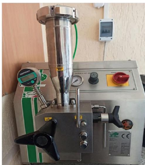
Рис. 3. Лабораторный гомогенизатор марки «FBI»
