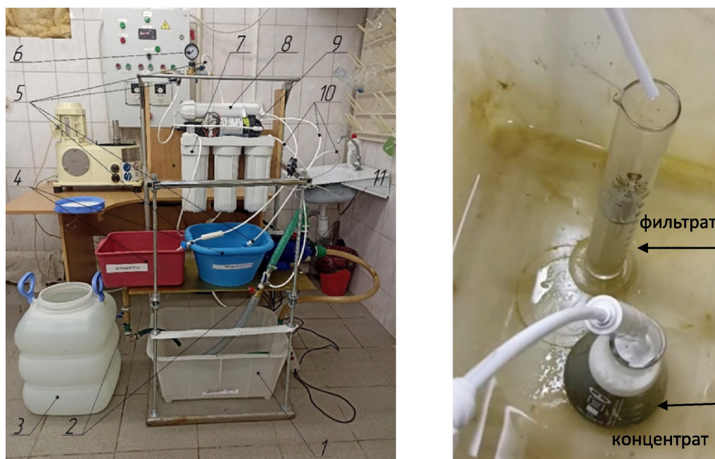
1 — емкость для исходного сырья; 2,5 — запорная арматура; 3 — емкость с дистиллированной водой для промывки мембран; 4 — емкости для концентрата и фильтрата; 6 — манометр; 7 — блок механической очистки; 8 — корпус мембраны; 9 — вспомогательный насос мембранного типа; 10 — патрубки; 11 — подающий центробежный насос
