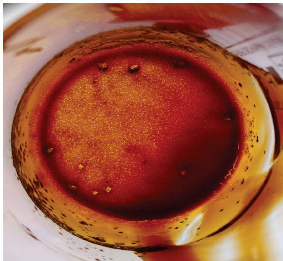
Рис. 2. Меласса со степенью деминерализации 43,0 % после кристаллизации охлаждением Fig. 2. Molasses with a degree of demineralization of 43.0% after crystallization by cooling
