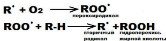
Рис. 3. Образование пероксидного радикала и промежуточного гидропероксида (гидроперекиси)
