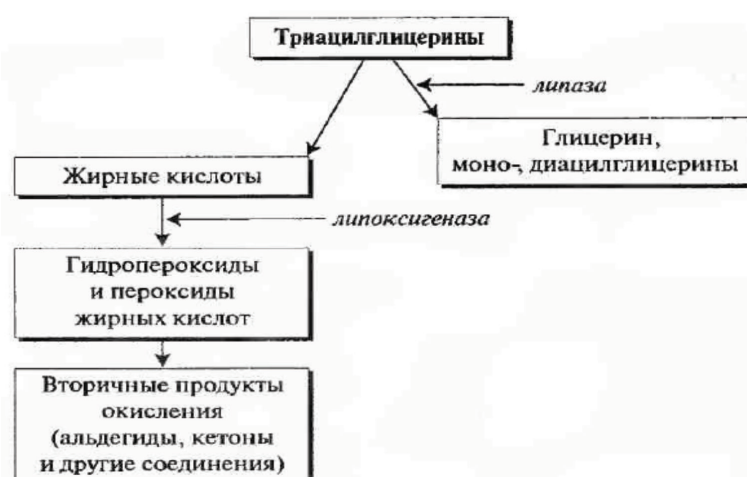
Рис. 6. Общая схема ферментативного прогоркания жиров [23] Fig. 6. General scheme of enzymatic rancidity of fats [23]
