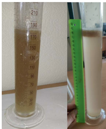
Рис. 1. Процесс разделения картофельной кашки в соляном растворе \rho \approx 1,25 кг/м 3 Fig. 1. The process of separating potato mash in a saline solution \rho \approx 1.25 kg/m 3
