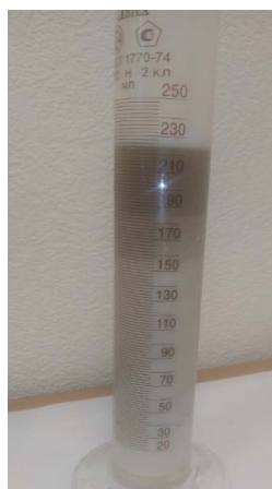
Рис. 3. Разделение суспензии крахмального молочка Fig. 3. Separation of starch milk suspension
