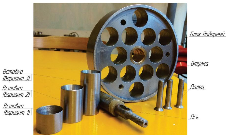
Рис. 2. Фотография конфузурно-диффузорных вставок
