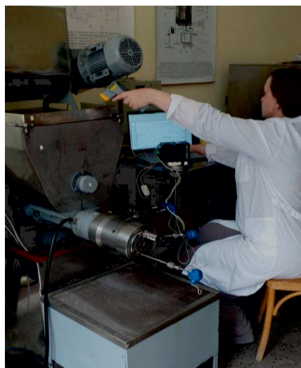
а – загрузка муки в бункер смесителя; б – регулирование контрольно-измерительных приборов и компьютерной системы контроля основных параметров процесса и измерение температуры теста в прессующем корпусе Рис. 3. Проведение испытаний на экспериментальном стенде Fig. 3. Conducting tests on the experimental test bench
