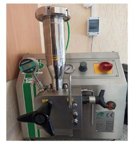
Рис. 3. Лабораторный гомогенизатор марки «FBI» Fig. 3. Laboratory homogenizer brand "FBI"
