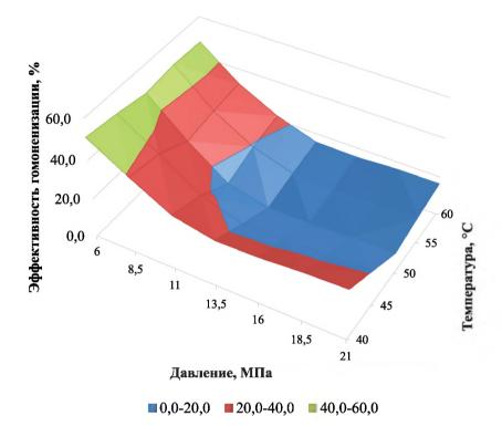
*Puc. 5.* Зависимость показателя эффективности гомогенизации от температуры и давления *Fig. 5.* Dependence of homogenization efficiency indicator on temperature and pressure
