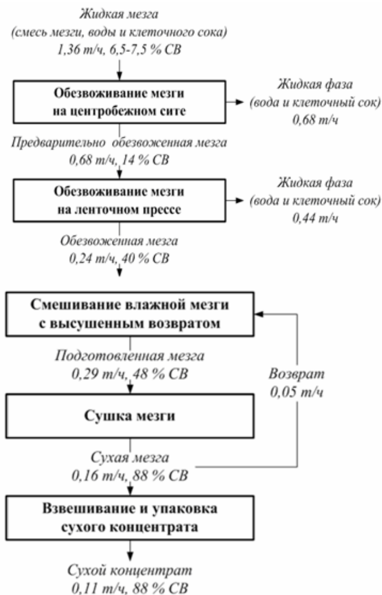
Рис. 4. Принципиальная технологическая процессуальная схема процесса производства сухого концентрата
