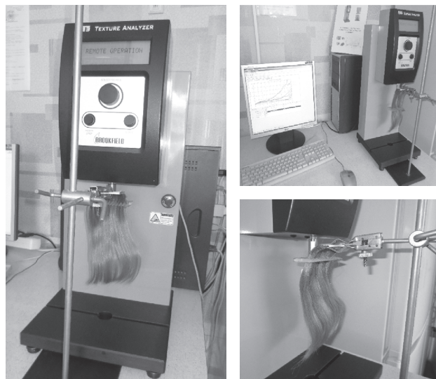
Рис. 5. Измерение расчесываемости прядей волос на текстурометре Brookfield
