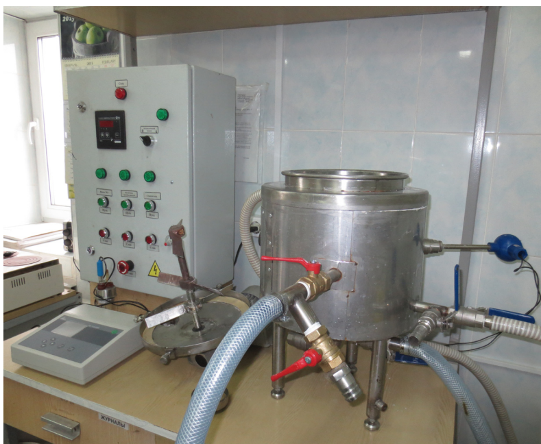
Рис. 5. Установка гидролиза крахмала Ш12-УГК
