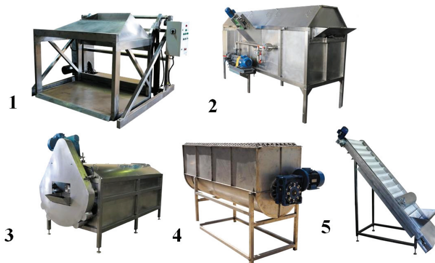
Рис. 2. Отдельные единицы оборудования многофункциональной линии по вакуумированию картофеля и топинамбура: 1 — контейнероопрокидыватель Ш12-ККТ, 2 — машина моечная барабанная Ш12-ММТ, 3 — машина моечная щёточного типа Ш12-МШТ, 4 — ванна обработки растворами пищевых добавок Ш12-ВОД, 5 — конвейер передающий Ш12 — КПД
