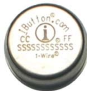
Рис. 1. Электронный идентификатор – технохрон DS1922
