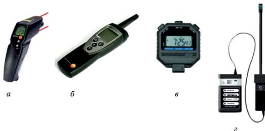
Рис. 3. Измерительное оборудование: а – пирометр инфракрасный testo 830-T2; б – прибор для измерения влажности и температуры testo 625; в – секундомер электронный ZS-2B; г – прибор комбинированный ТКА-ПКМ (50)
