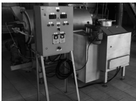
Рис. 1. Установка Ш12-УСО для комбинированной сушки дрожжевого концентрата
