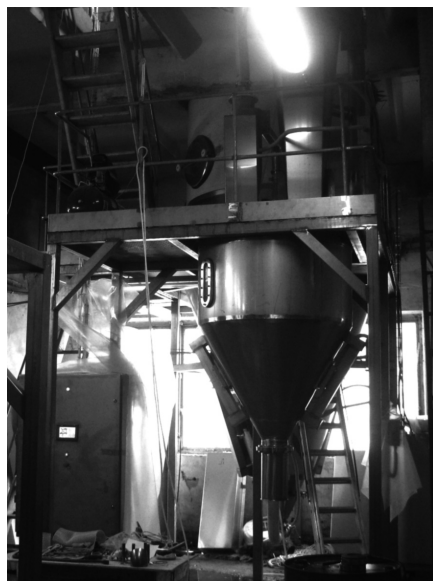
Рис. 7. Опытный образец сушильной установки Я23-ОСУ
