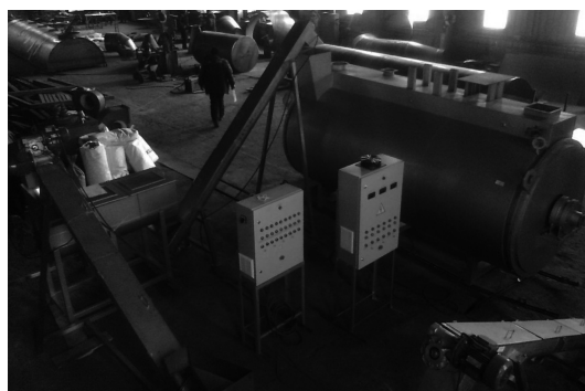
Рис. 6. Основные единицы опытного образца оборудования для переработки картофельной мезги: а — участка механического обезвоживания картофельной мезги (центрифуга, пресс); б — участка подготовки к сушке и сушки картофельной мезги (транспортирующие конвейеры, смеситель, установка сушильная)
