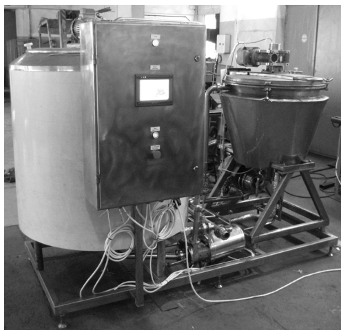
Рис. Комплекс оборудования для производства пастообразных продуктов на молочной основе Я23-ОДА
