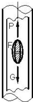
где  $G$  – вес частицы, Н;  $P$  – сила, действующая на частицу в направлении снизу вверх под воздействием воздушного потока, Н.
