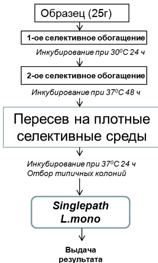
Рис. 3. Схема идентификации L. monocytogenes с использованием тест-систем Singlepath® L.'mono
