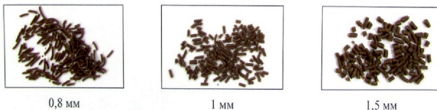
Рис. 2. Микрогранулы комбикорма, диаметром: 0,8 мм, 1 мм, 1,5 мм Fig. 2. Mixed feed microgranules, with a diameter of: 0.8 mm, 1 mm, 1.5 mm
