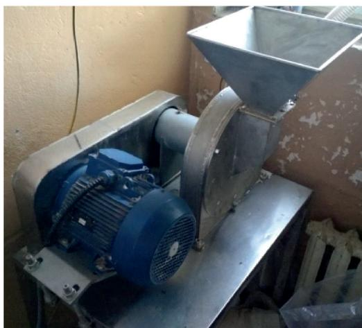
Рис. 1. Дробилка Ш12-ДСК: 1 — загрузочный бункер; 2 — корпус; 3 — опора;
