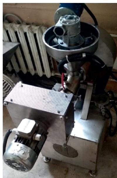
Рис. 4. Экструдер Ш12-РЭК: 1 — корпус; 2 — шнек; 3 — фильера; 4 — шнековый питатель; 5 — привод шнека; 6 — нож с приводом для обрезки гранул; 7 — рама
