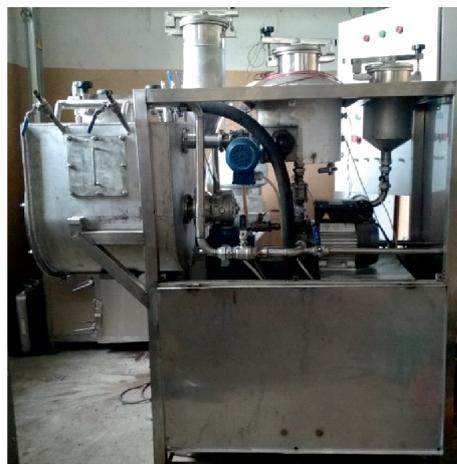
Рис. 7. Обмасливател Ш12-РНВ: 1 — рама, 2 — корпус с вакуумной камерой и валом с лопатками, 3 — привод вала, 4 — система вакуумирования, 5 — система подогрева и распыла масла, 6 — система подачи порошкообразных компонентов, 7 — система подачи жидких компонентов, 8 — насосы для подачи жидкостей, 9 — контрольно-измерительные приборы, 10 — пульт управления
