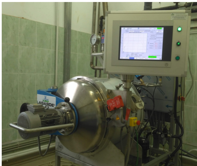
Рис.3. Лабораторный автоклав Lagarde Франция с системой сбора и регистрации температур Samanta Fig.3. Lagarde France laboratory autoclave with Samanta temperature collection and registering system
