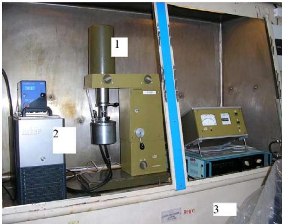
Рис. 2. Комплекс для определения реологических характеристик пищевых продуктов: 1 — вискозиметр Rheotest 2.1, 2 — термостат Huber CC1, 3 — вытяжной шкаф
