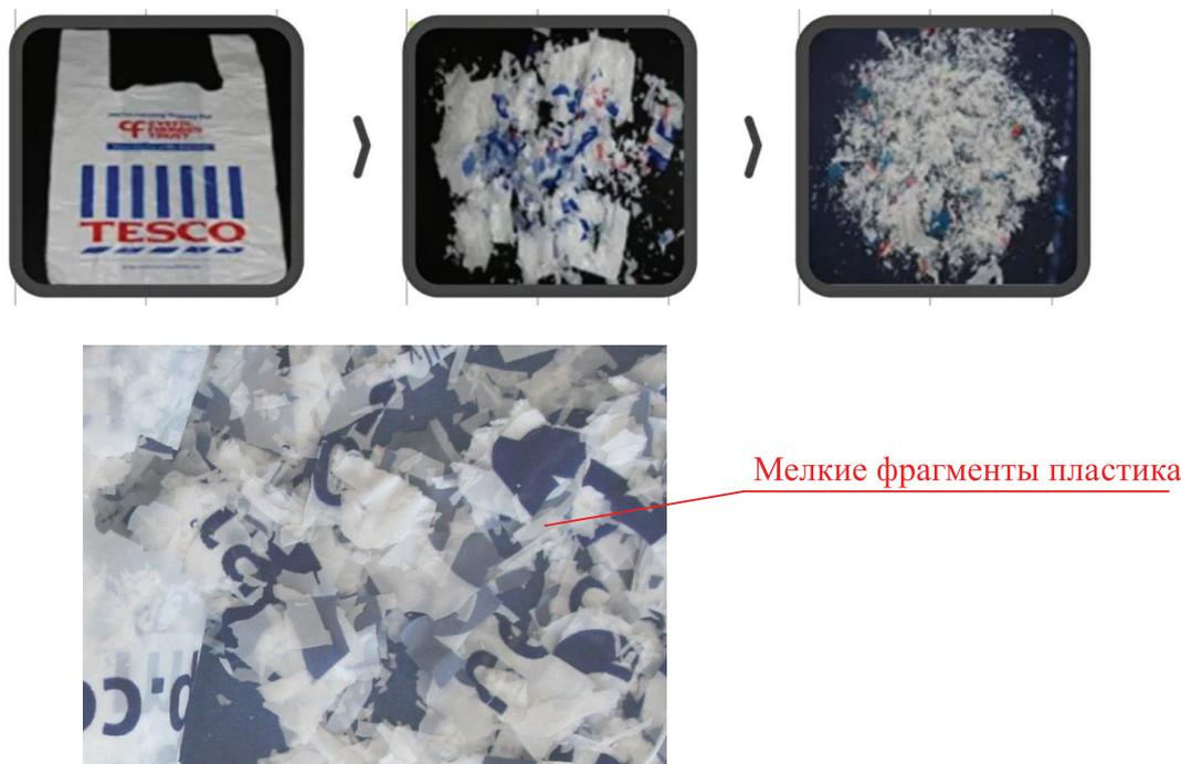
Рис. 2. Пример фоторазложения оксоразлагаемого пакета типа «майка» при попадании прямых солнечных лучей
