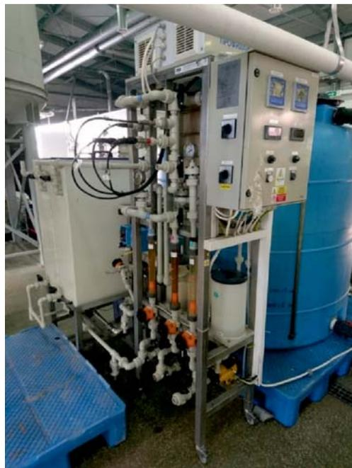
Рис. 2. Пилотная электродиализная установка ED(R) — Y
