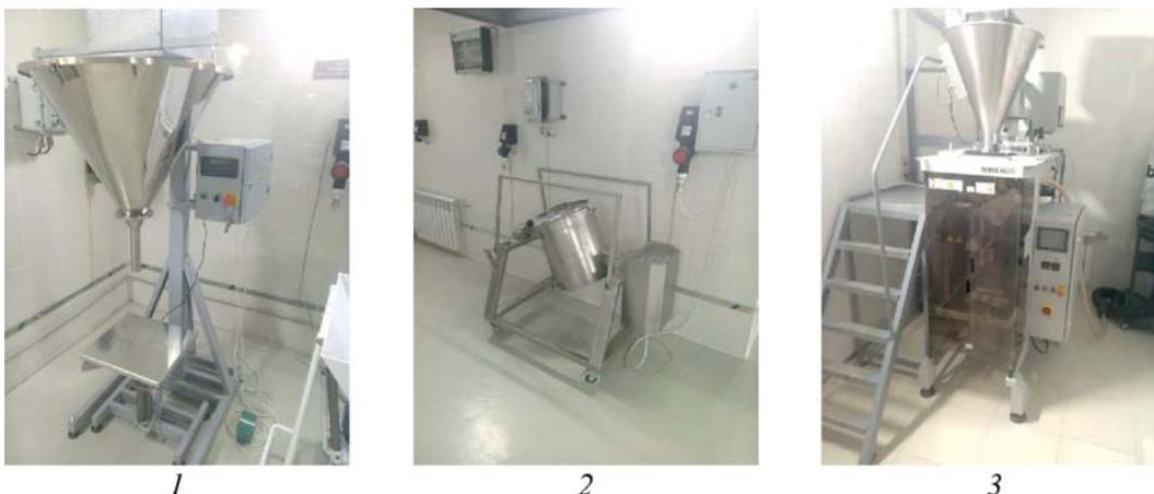
Рис. 4. Линия по производству сухих смесей:
