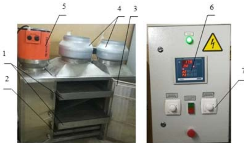
1 — лотки с сетчатым дном для сушки гранул, 2 — лоток для сбора крошки, 3 — дверь, 4 — вентиляторы канальные, 5 — электронагреватель, 6 — цифровое табло, 7 — пульт управления (регулировка температуры по зонам сушки, скорость вращения туннельных вентиляторов)
