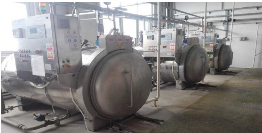
Рис. 5. Горизонтальный автоклав Levati PRIMA Fig. 5. Levati PRIMA horizontal autoclave
