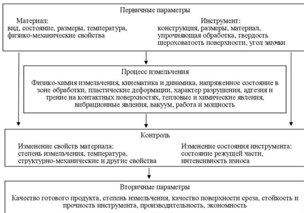
Рис. 1. Структурная схема измельчения мяса и мясных продуктов Fig. 1. Block diagram of meat and meat products grinding
