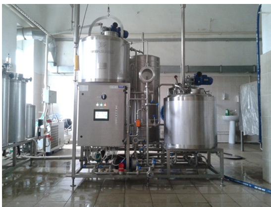
Рис. 1. Микропивоварня «Orion-100» Fig. 1. Microbrewery «Orion-100»
