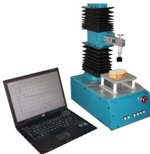
Рис. 1. Прибор «Структурометр СТ-2» Fig. 1. Instrument «Structurometer ST-2»
