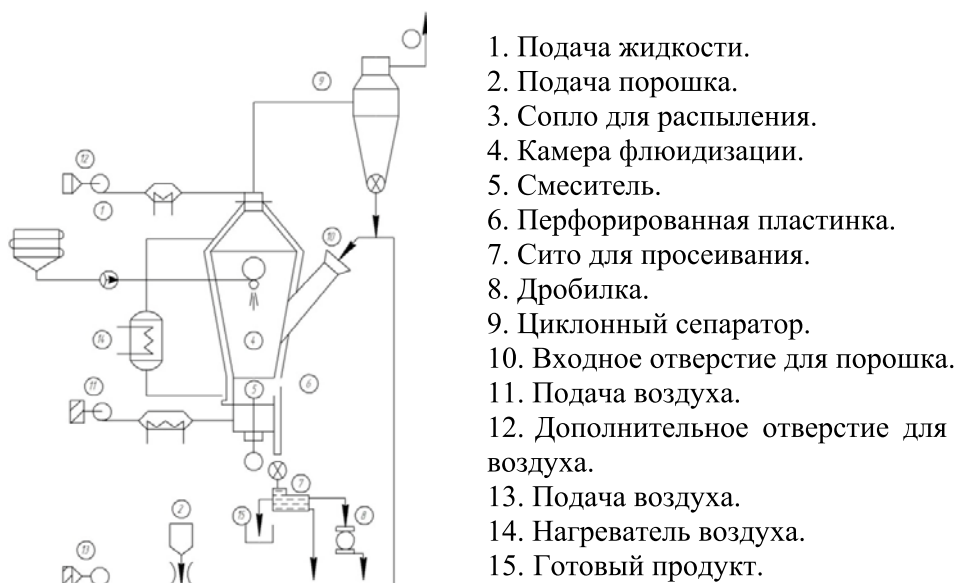
Рис. 1. Схема распылительной сушилки фирмы «Anhydro»
