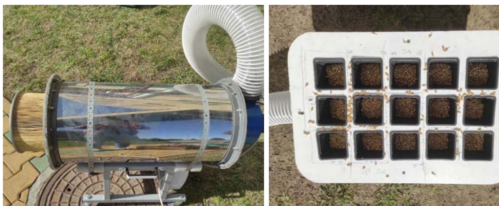
Рис. 2. Обработка свежемолотого солода электроактивированным воздухом
