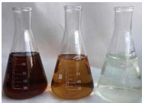
Рис. 4. Изменение цветности сахарного сиропа в результате электродеионизации (слева направо: сироп до обработки, деминерализованный сироп, концентрат)
