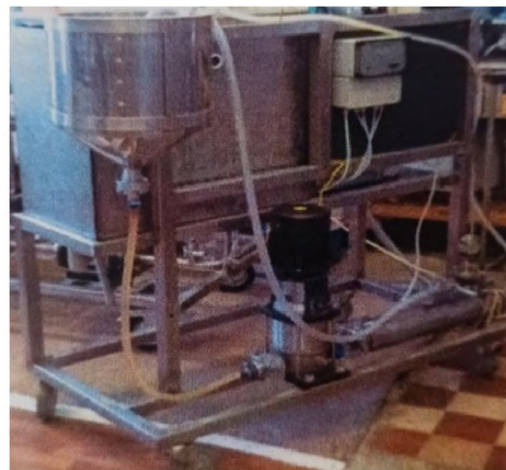
Рис. 2. Лабораторная ультрафильтрационная установка Я23-ОУФ Fig. 2. Laboratory ultrafiltration unit Ya23-OUF
