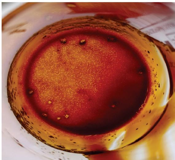
Рис. 2. Меласса со степенью деминерализации 43,0 % после кристаллизации охлаждением
