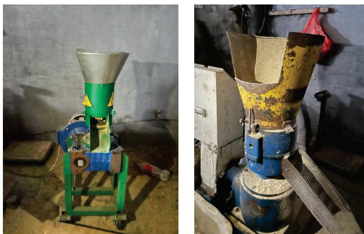
Рис. 1. Лабораторные грануляторы
