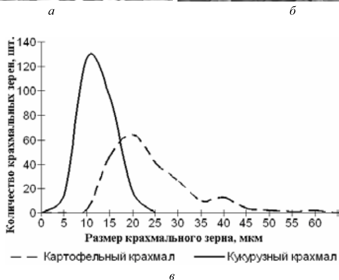
Рис. 5. Морфологическая характеристика нативных крахмалов: а — картофельный; б — кукурузный; в — распределение гранул по размеру
