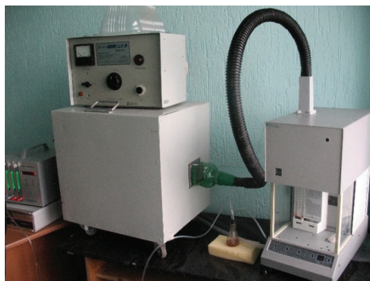
Рис. 2. Установка для обработки суспензии конидий Aspergillus niger
